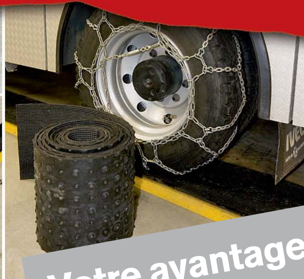
Les chaînes à neige détériorent le sol des halles.
