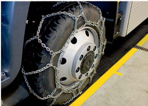
Les chaînes à neige détériorent le sol des halles.
